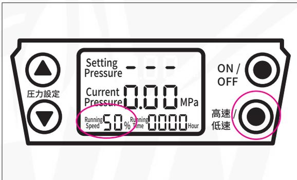
**5** 按下控制面板上的電源開關啟動空壓機。首次使用或在寒冷天氣時，請選擇低速（50%），待空氣充滿後，繼續放氣約5分鐘，或鬆開放水閥門繼續預熱。
