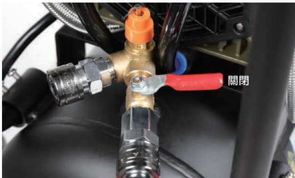
**2** 滑動連接環以斷開空壓管。此時，如果空壓管內的空氣沒有完全排除，空壓管可能會猛烈甩開，容易發生危險。
