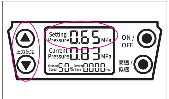
**7** 按下高速/低速按鈕調整空壓機轉速。高速（99%）/低速（50%）。
